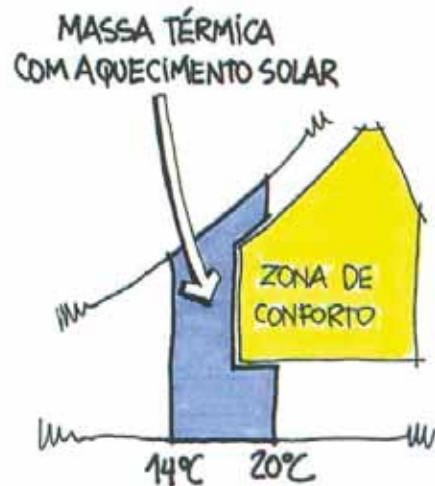
Zona de massa térmica e aquecimento solar
