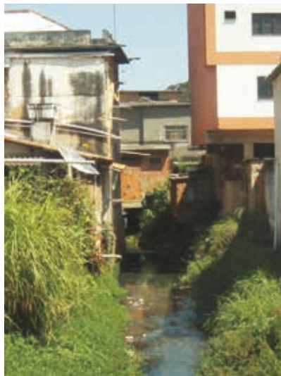
Esgoto lançado in natura em cursos d'água na ausência de rede de coleta de esgoto.
